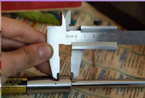
Отмеряем от дна картриджа 23мм и керном делаем вмятину в корпусе картриджа. Это необходимо для фиксации поршня в самом дне картриджа. Дальше отмеряем 35мм от дна картриджа и сверлим дырку. Может опять масло вшикнуть.
